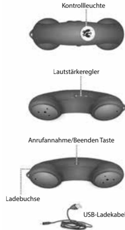
Bevor Sie Ihr „Mini-Freak“ Bluetooth Phone in Betrieb nehmen können, muss der Akku vollständig geladen werden. Ein USB-Ladekabel wird mitgeliefert. Wenn Sie ein anderes Ladegerät verwenden möchten, so braucht es die Eigenschaften 5V.0.3A Das „Mini-Freak“ Bluetooth Phone verfügt über einen fest installierten, nicht auswechselbaren Akku. Versuchen Sie nicht, diesen zu entfernen oder zu ersetzen, da das Gerät beschädigt werden könnte.
